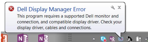
Upozorňujeme vás, že DDM funguje pouze u monitorů značky Dell. Používáte-li monitory jiných výrobců, DDM je nepodporuje.
