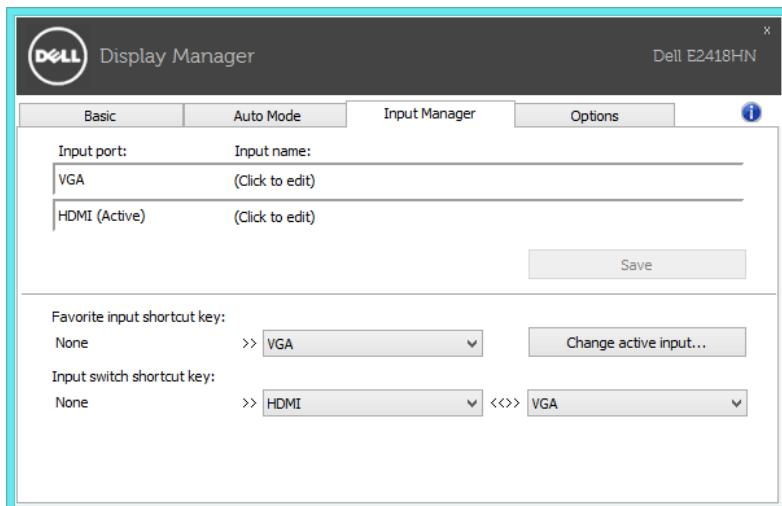
Můžete přepnout na libovolný vstup pomocí rozevíracího seznamu.
