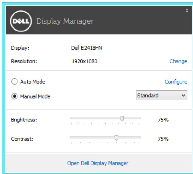
Dialogové okno Rychlá nastavení umožňuje rovněž přístup rozhraní pro pokročilé uživatele nástroje Dell Display Manager, které se používá k nastavování základních funkcí, ke konfigurování automatického režimu a pro přístup k dalším funkcím.
