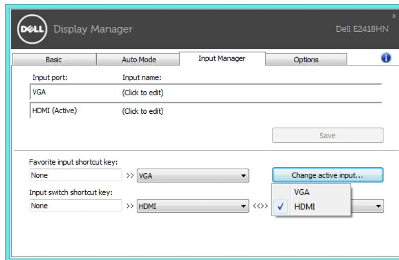
**POZNÁMKA:** DDM komunikuje s vaším monitorem, i když monitor zobrazuje video z jiného počítače. Můžete nainstalovat DDM do počítače, který často používáte, a přepínat z něho vstupy. DDM můžete rovněž nainstalovat do jiných počítačů, které jsou připojené k monitoru.
